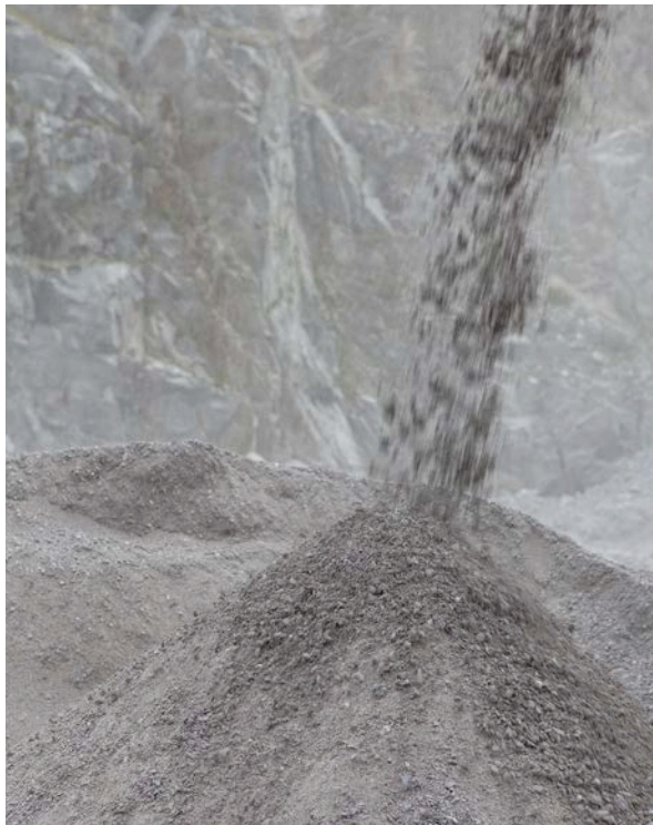
Durch das Mischen mit unbelastetem Material kann die PAK-Konzentration beim Ausbruchasphalt gesenkt werden. Dadurch erhöht sich jedoch die Gesamtmenge des Recyclingasphalts.
